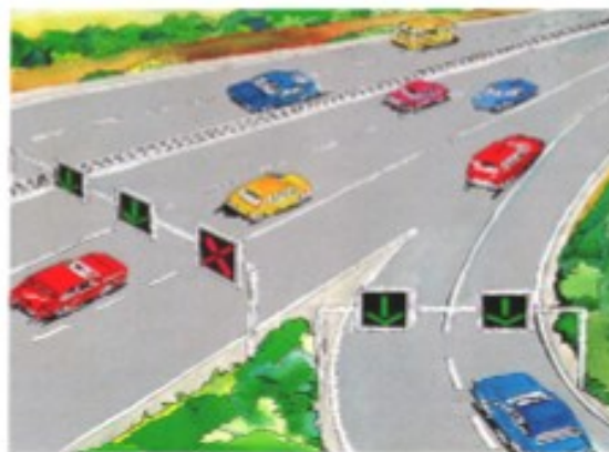
Bild 10: Prinzipskizze Variable Fahrstreifenzuteilung
